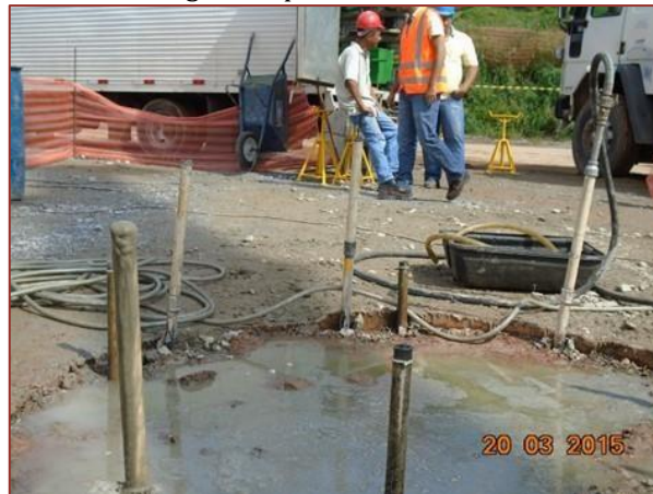
Figura 16. Detalhe da calda de cimento injetada em um tubo e saindo em outro após percolar a fissura gerada pelo ensaio.
