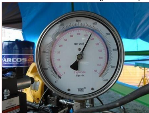
Figura 14. Detalhe do manômetro da bomba registrando a pressão aplicada.
