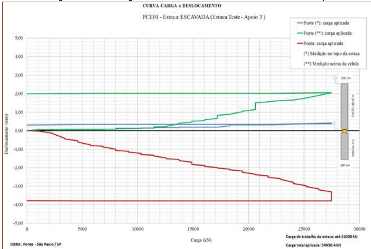
Figura 4. Curva3 - carga x deslocamento da estaca testada com as duas medições.
