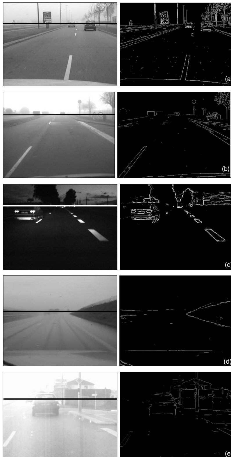
FIG. 15 – Gauche: image originale et ligne horizontale représentative de la distance de visibilité mobilisée. Droite: primitives de contraste au sens de Weber supérieur à 5 % (a) Brouillard léger ( V_{mob} \approx 200 m), (b) brouillard dense ( V_{mob} \approx 50 m), (c) nuit ( V_{mob} \approx 250 m), (d) pluie forte ( V_{mob} \approx 60 m), (e) éblouissement ( V_{mob} \approx 40 m).
