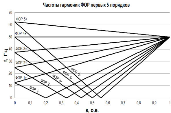
Рис. 15. Частоты гармоник ДЭ (а) и ФОР (б) с высокими амплитудами для двигателя с 4 парами полюсов
