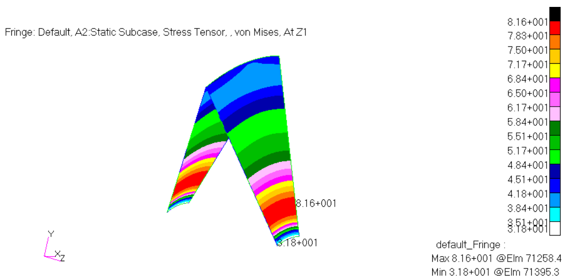
Figura 4.12 – Tensões de von Mises nos cones de rigidez ( \text{N/mm}^2 ) - superfície Z1
