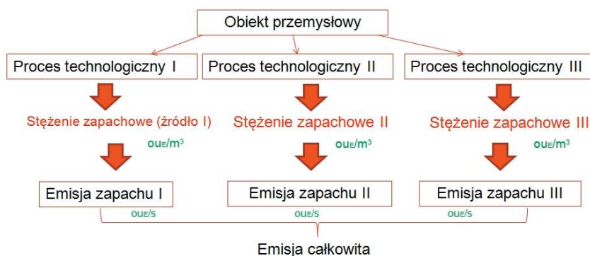
Rys. 4.7. Schemat ideowy związany z określeniem emisji zapachu z wybranego zakładu przemysłowego z zastosowaniem olfaktometrii dynamicznej
