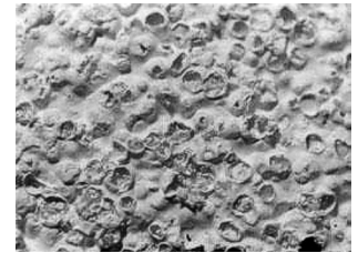
Figura 2. Detalle de la superficie de una placa ensayada (fórmula N° 3) donde se observan las cavidades que dejan las perlas de EPS después de ser expuestas al fuego.
