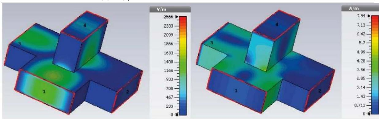
Рисунок 7 – Распределение полей (а – электрическое, б – магнитное)
