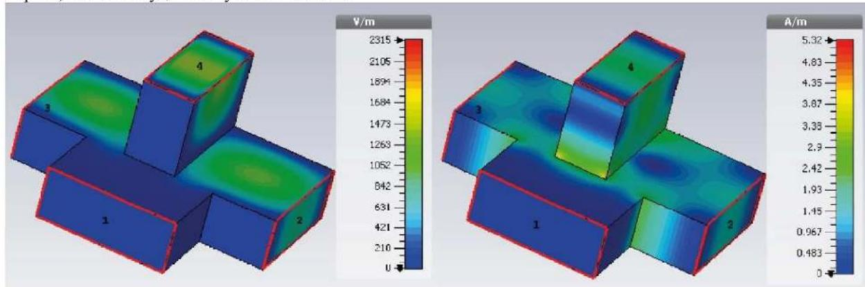
Рисунок 6 – Распределение полей (а – электрическое, б – магнитное)
