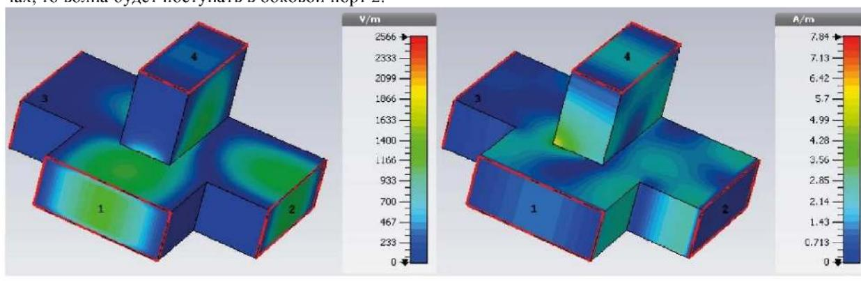
Рисунок 8 – Распределение полей (а – электрическое, б – магнитное)
