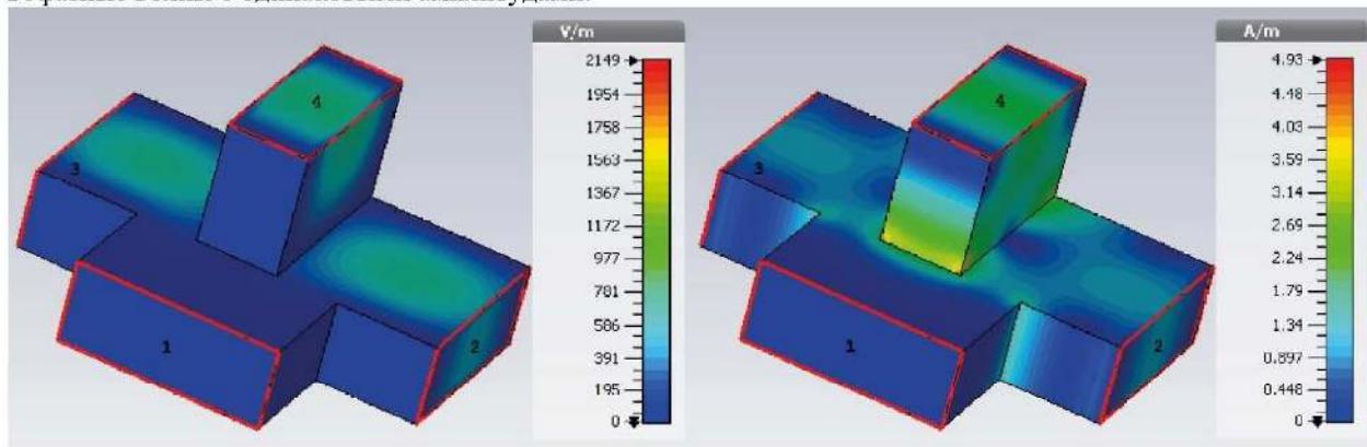
Рисунок 5 – Распределение полей (а – электрическое, б – магнитное)
