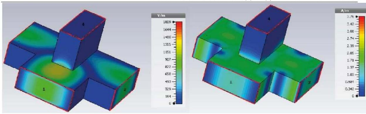
Рисунок 4 – Распределение полей (а – электрическое, б – магнитное)
