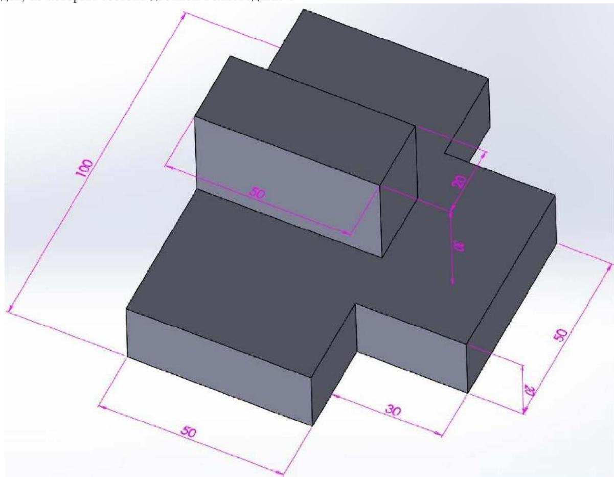
Рисунок 2 – Геометрические размеры двойного волноводного тройника
