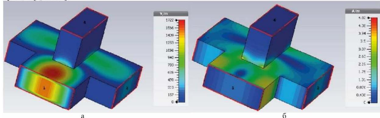
Рисунок 3 – Распределение полей (а – электрическое, б – магнитное)
