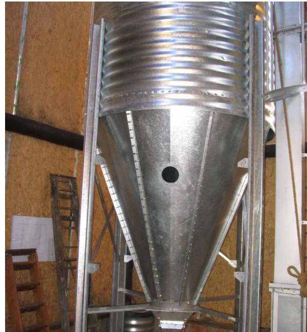
Figura 7.23 – Visão geral do silo de armazenamento montado.
