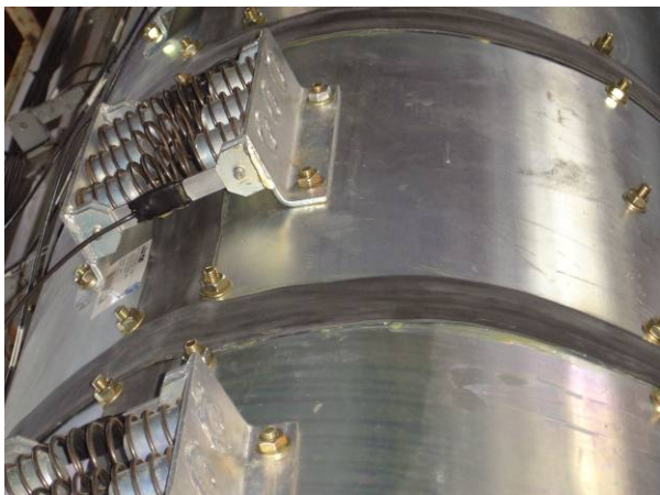
Figura 7.12 – Sistema de vedação do silo-piloto com borrachas coladas.
