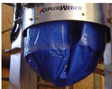
Figura 7.37 – Colocação da lona plástica.
