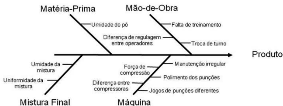
Figura 1. Representação do diagrama de espinha de peixe para produção de comprimidos de ibuprofeno.
