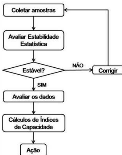
Figura 2. Fluxograma referente às etapas de determinação da estabilidade e capacidade do processo. Montgomery, 2004 (adaptado).
