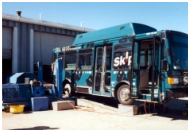
Autobús comercial en Boulder, Colorado, sometido a pruebas en el dinamómetro portátil de chasis de la West Virginia University. Paul Norton, NREL/PIX 06651
