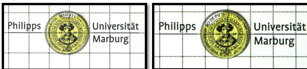
Abbildung 64. PMAC8PC-Ronde vor dem Suntest (links) und nach 12 Tagen im Suntest (rechts). Bestrahlt wurde mit 500\text{ W/m}^2 bei 50\text{ °C} .
