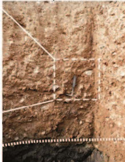
Figura 4. Descripción sedimentaria de los suelos en la calicata C1. Se reconocen niveles de suelos gravo arcillosos mal gradados (GC) y limo-areno arcillosos con gravas dispersas en la base (SP)
