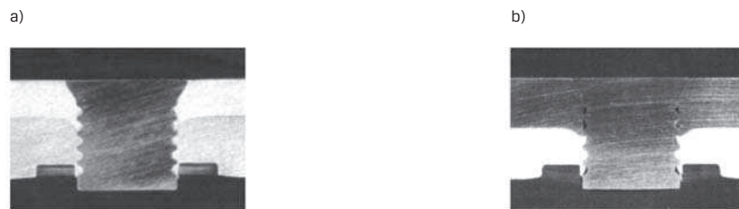
Rys. 5. Kombinacja połączenia blach aluminiowych oraz stalowej i aluminiowej: a) EN AW-6181A ( g_1 = 1.5 mm)/EN AW-5754 ( g_2 = 2.5 mm), b) EN 10130 (2.0 mm)/EN AW-5754 ( g_2 = 2.0 mm).
