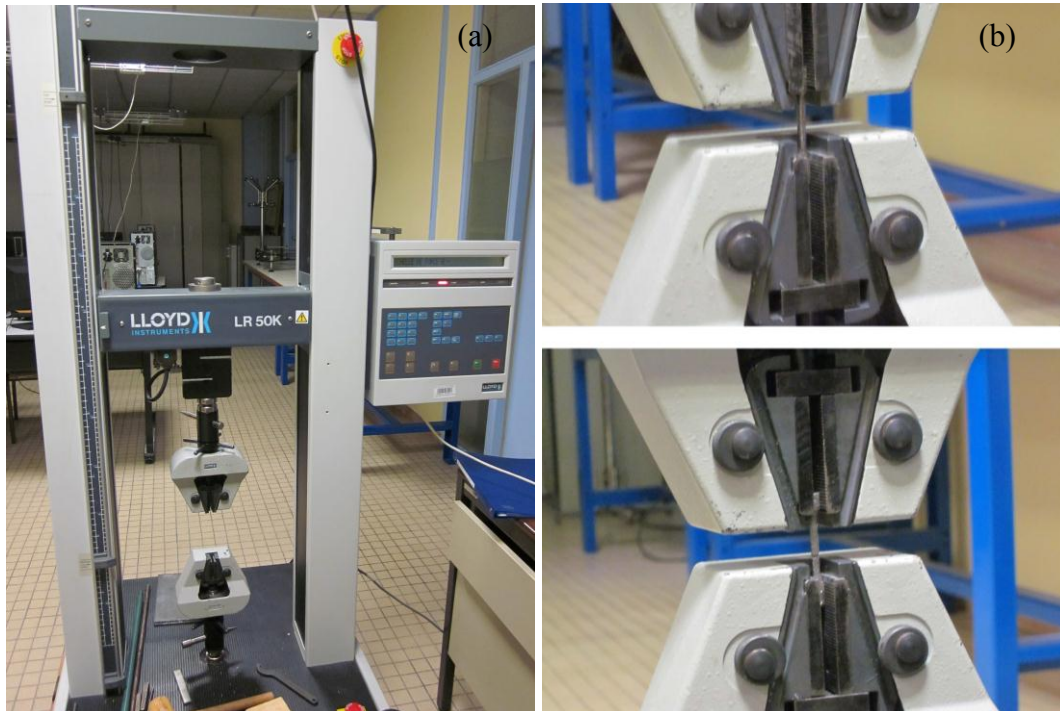
Figure II.10 Photographies montrant la machine utilisée pour les essais de traction.
