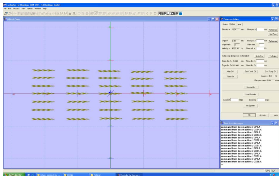
Figure II.6 Capture d’écran de l’interface logicielle montrant les 35 cordons réalisés avec les paramètres présentés dans le Tableau II.1.
