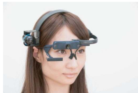
図2 脳波と視線の動きの同時計測
