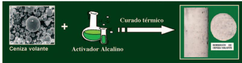
Fig. 2: Representación esquemática del proceso de activación alcalina de cenizas volantes
