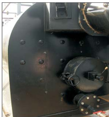
Figure 1 Measurement points along the boiler rear head Slika 1. Mjerna mjesta na stražnjem dancu kotla
