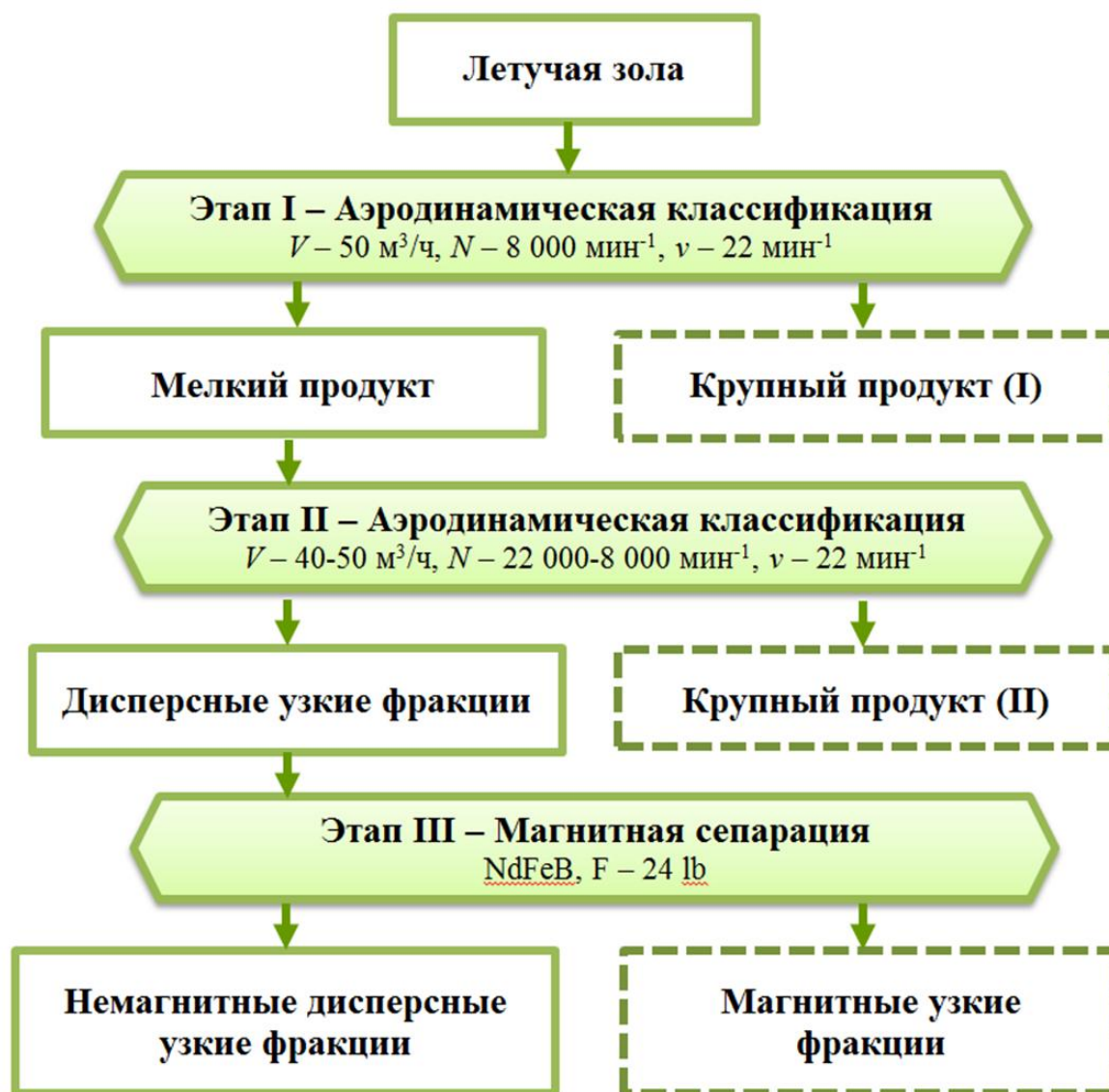
Схема 1 – Технологическая схема выделения дисперсных узких фракций из летучей золы 1 поля электрофильтра Рефтинской ГРЭС
