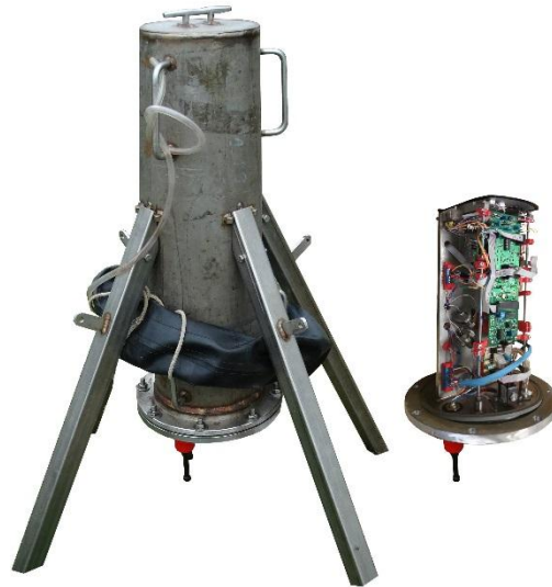
Рис. 1 – Фото ИФД в сборе (слева) и без герметичного корпуса (справа)
