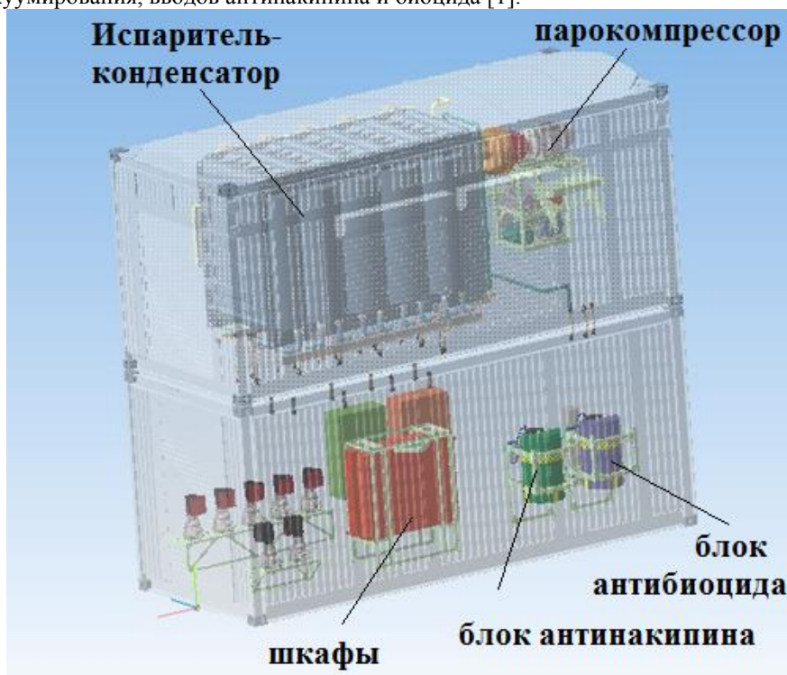
Рис. 1 – Классическая компоновка дистилляционной опреснительной установки
