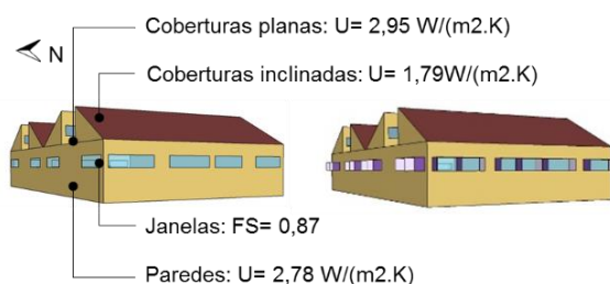
Figura 1: Modelo do EnergyPlus para o caso base (à esquerda) e caso 2 (à direita).
