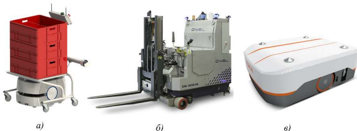
Рис. 4. Мобильные промышленные роботы: Omron Lynx (а); Dival DAV 4000-GS (б); KUKA KMP 600 (в).
