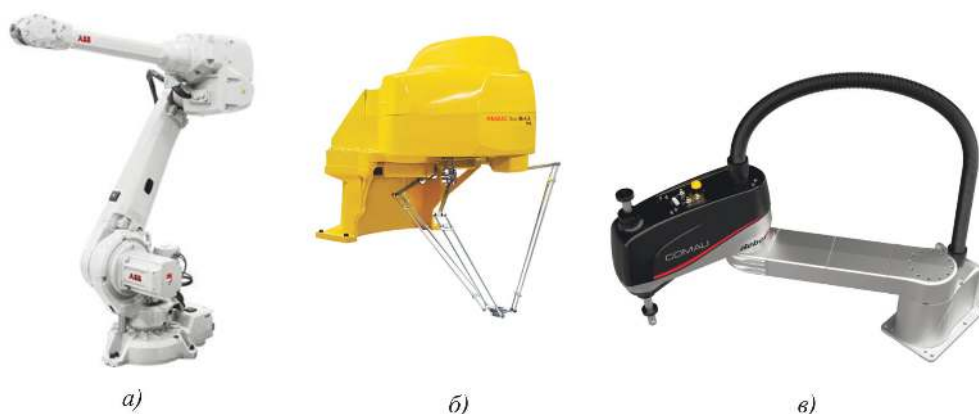
Рис. 2. Манипуляционные промышленные роботы: а) ABB IRB 4600, ангулярная кинематическая схема;
