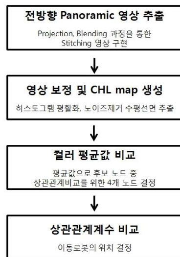
그림 7. 제안된 이동 로봇의 최단 노드 결정 흐름도.
