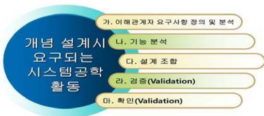
그림 1. 개념설계 시 요구되는 시스템공학 활동 [6] Fig. 1. Systems engineering activities required in the conceptual design phase [6]
