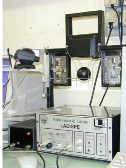
Figure 1: The Magnetic Levitator experimental setup developed by “ Laboratorio Didattico Sperimentale ” (LADISPE), Politecnico di Torino
