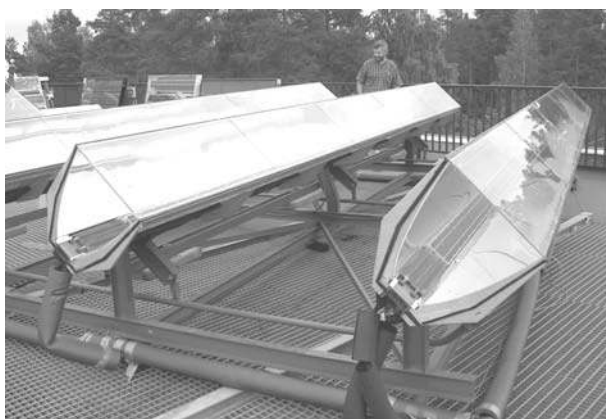
Ett "solkraftvärmeverk" med vattenkylda kisel-solceller, paraboliska reflektorer och täckglas, som ger både el och värme. Systemet finns hos Vattenfall Utveckling AB i Älvkarleby. Professor Björn Karlsson syns i bakgrunden. Foto: Maria Brogren.
