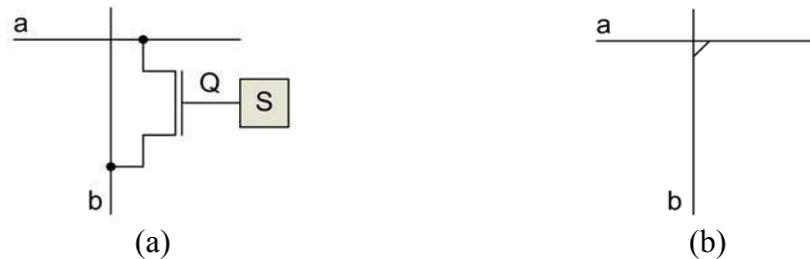
**Abbildung 2-2:** Programmierbare Verbindung über einen gesteuerten Pass-Transistor (a), vereinfachte Darstellung (b).
