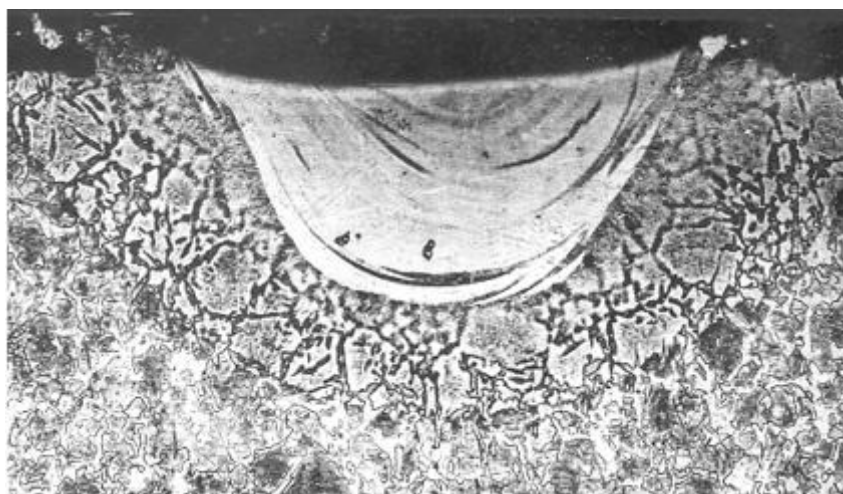
Рис. 2. Микроструктура стали 45 после лазерного легирования Mo в условиях непрерывного излучения, P = 1\text{ кВт} , V = 15\text{ мм/с} , \times 100
