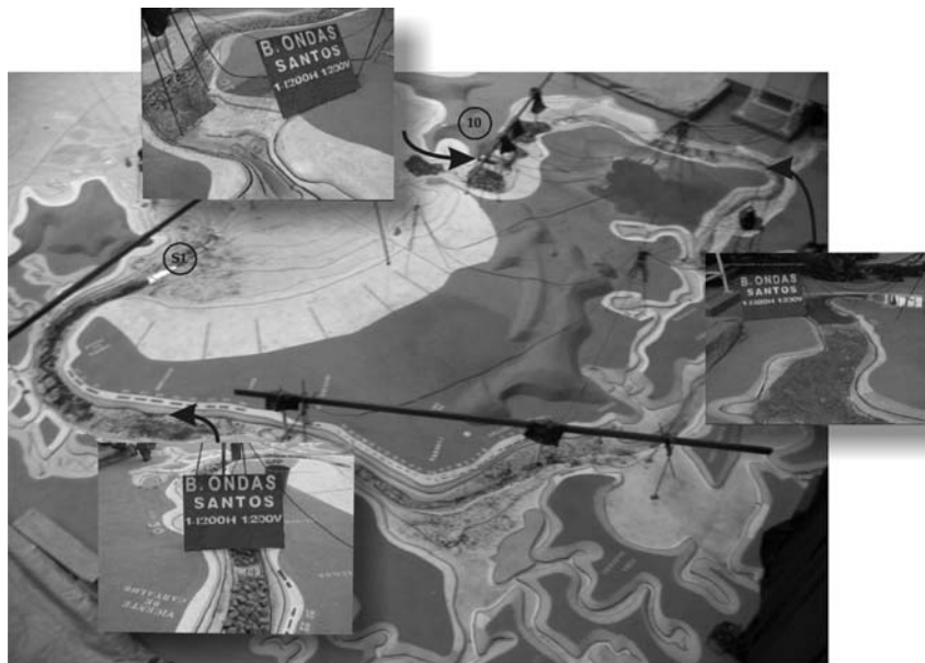
Figura 5 —Calibração da rugosidade no modelo por meio do ajuste da granulometria de pedregulhos argamassados no fundo dos canais estuarinos.
