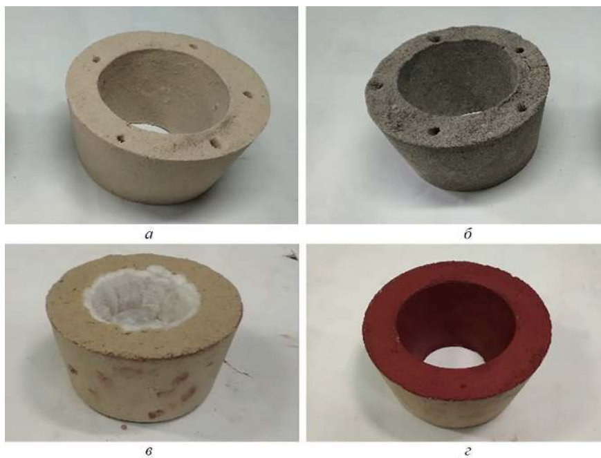
Рис. 10. Внешний вид теплоизолирующих вставок: а – кварцевый песок; б – состав № 3; в – вставка из ММРР-130; г – обмазка экзосмесью
