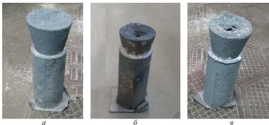
Рис. 11. Отливки с прибыльной частью, полученные с применением вставок различного состава: а – без утепления; б – со вставкой из композита № 3; в – с обмазкой песчаной надставки экзотермической смесью
