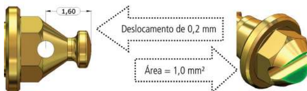
Figura 5 - Modelo de parafuso ortodôntico com recuo de 0,2 mm em relação ao modelo original e representação da área da seção resistente no ponto mais crítico.
