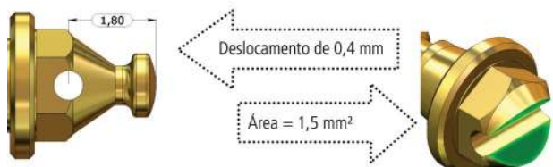
Figura 6 - Modelo de parafuso ortodôntico com recuo de 0,4 mm em relação ao modelo original e representação da área da seção resistente no ponto mais crítico.
