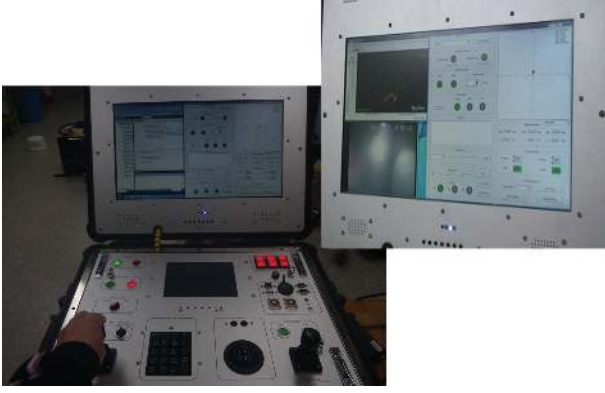
그림 5. P-SURO II AUV의 선상 원격제어 시스템.
