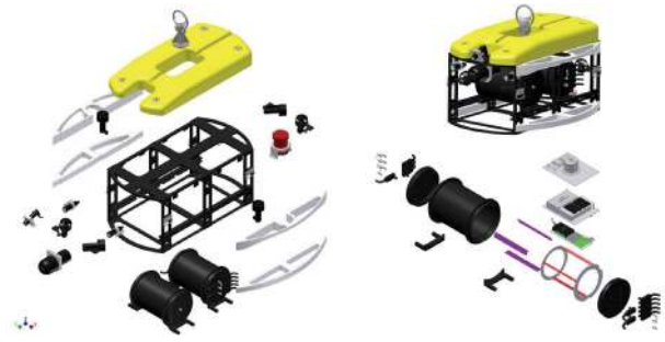
그림 3. P-SURO II 하이브리드 AUV의 분해 조립도. Fig. 3. Exploded view of P-SURO II hybrid AUV.
