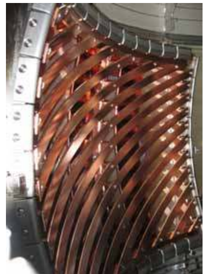
FIG. 1. TST-2 HHFW Antenna.
