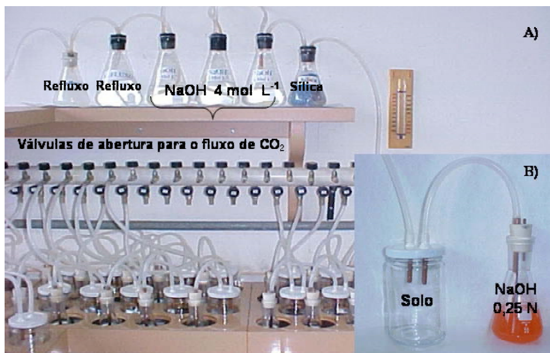
Figura 2 - A) - equipamento respirométrico utilizado para avaliação da evolução de C-CO 2 , em Argissolo Vermelho-Amarelo incubado durante 28 dias a 80% da sua capacidade de campo; e B) - unidade experimental de coleta do C-CO 2 evoluído.
