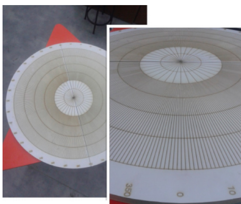
Figura 12 e 13 – Escala para o pêndulo realizada em router CNC
