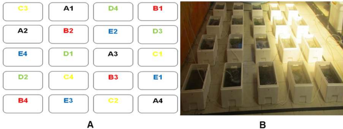
Gambar 4. Tata letak penelitian styrofoam pada penelitian, denah (A) dan kondisi nyata (B). Pasir lumpur PL (A1,A2,A3 & A4), karang pasir KP (B1,B2,B3 & B4), Karang Lumpur KL (C1,C2,C3 & C4), Karang K (D1,D2,D3 & D4) dan pasir P (E1,E2,E3 & E4).
