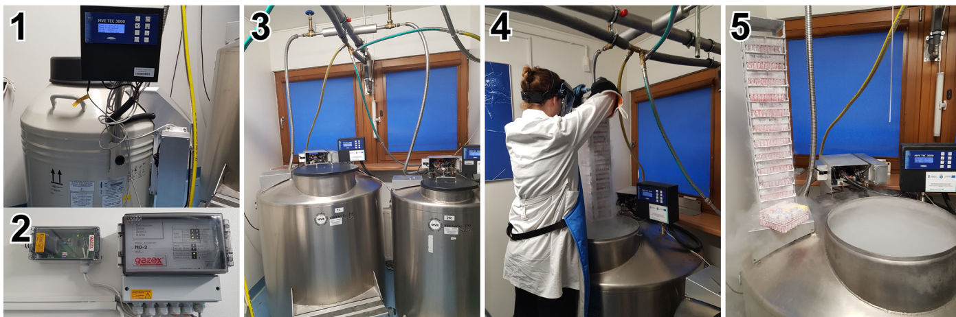
Rycina 5. Automatyczny system do przechowywania próbek z odpowiednio zamrożonymi komórkami (banków komórkowych) w LN (1) oraz w parach LN (faza gazowa LN; 3-5). Aby zapewnić bezpieczeństwo pracy należy stosować odpowiedni strój (fartuch, rękawice, okulary/maski ochronne) oraz monitorować zawartość tlenu w powietrzu, gdyż parujący LN może wypierać tlen z powietrza. System przeznaczony do monitoringu stężenia tlenu przedstawia fotografia 2.
