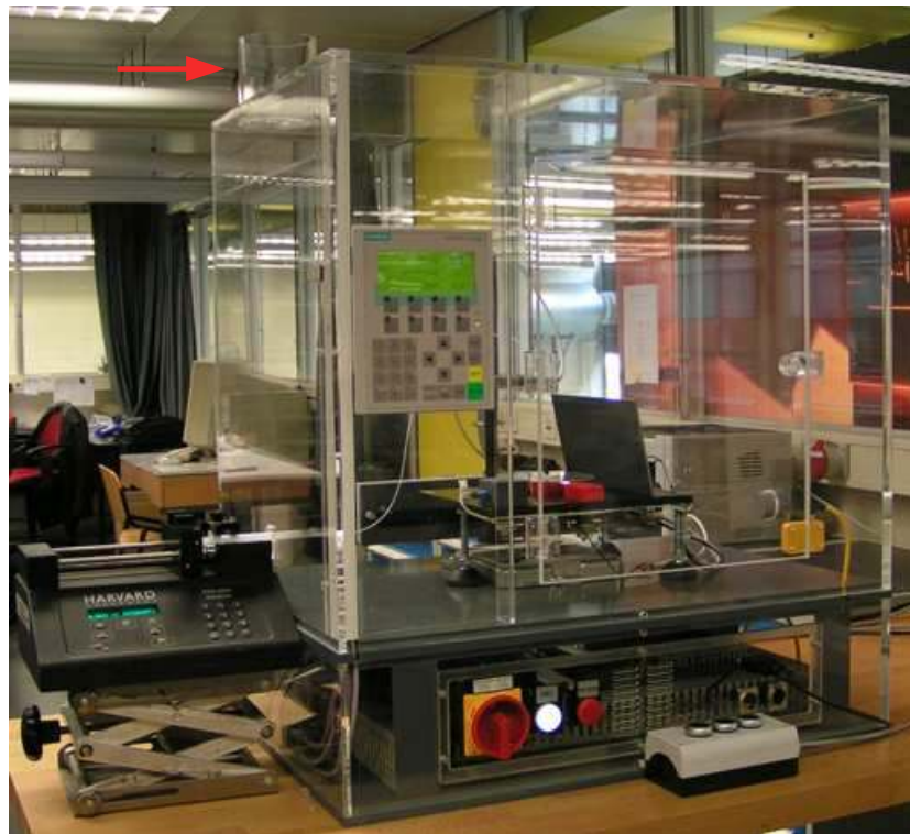
Figure A.1: E-spincabine met de rode pijl bij de afzuigopening.
