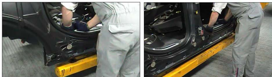
Figure 40- Analyse des contraintes au poste: frappes de main pour faire rentrer la pièce
