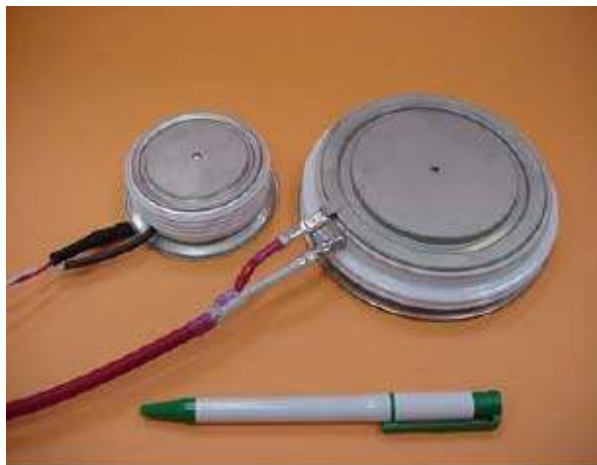
Fig. 4.4. 4500-V/800-A and 4500-V/1500-A thyristors [6].
