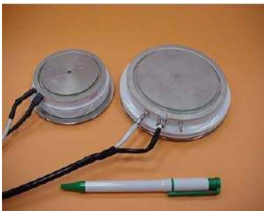
Fig. 4.5. 4500-V/800-A and 4500-V/1500-A GTOs [6].
