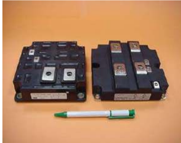
Fig. 4.8. 1700-V/1200-A and 3300-V/1200-A IGBT modules [6].
