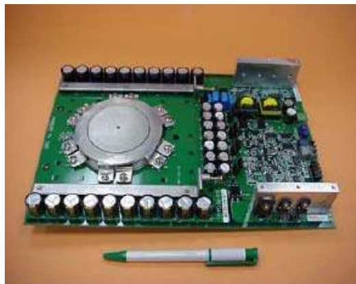
Fig. 4.6. 6500-V/1500-A symmetrical GCT [6].
