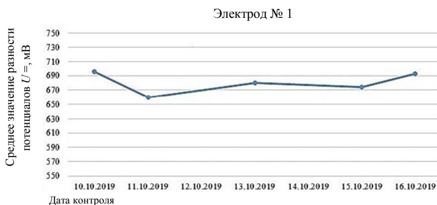
Рис. 1. Динамика результатов разности потенциалов в период с 10.10.2019 по 16.10.2019, полученных с помощью электрода № 1, изготовленного из электроугольного изделия для электрических машин
