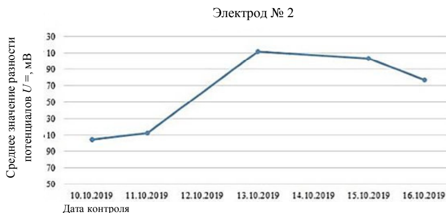
Рис. 2. Динамика результатов разности потенциалов в период с 10.10.2019 по 16.10.2019, полученных с помощью электрода № 2, изготовленного из судокорпусной стали
