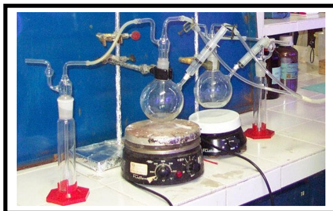
Figura 3.3: Sistema utilizado, nos laboratório da UFF, para o modelo de fracionamento \Sigma SEM/AVS.
