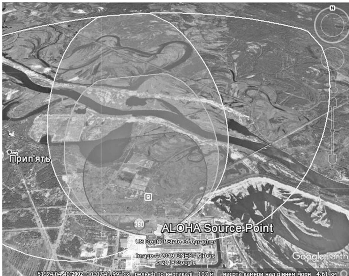
Рисунок 3 — Зона радіоактивного забруднення атмосфери під час аварії на Чорнобильській АЕС на момент 102 хв від вибуху реактора:  $S_{HC} = 23 \text{ км}^2$
