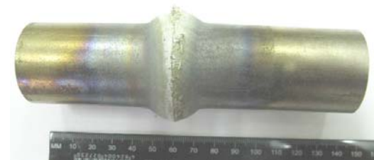
Рис. 1. Внешний вид опытных прессованных (а) и сварных (б) заготовок
