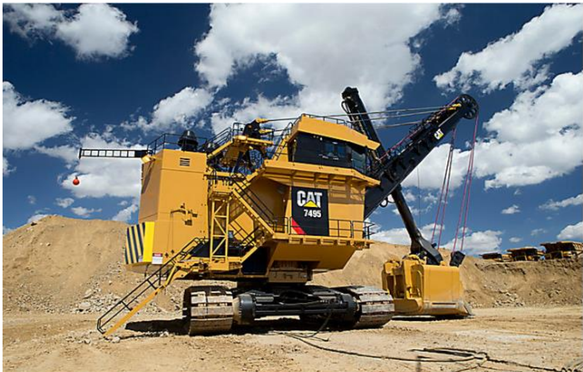
Figura 6 Escavadeira a cabo 7495 Caterpillar
