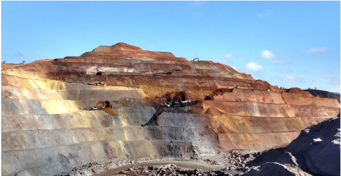
Figura 1 Lavra de minério de ferro pelo método de bancadas em encosta
