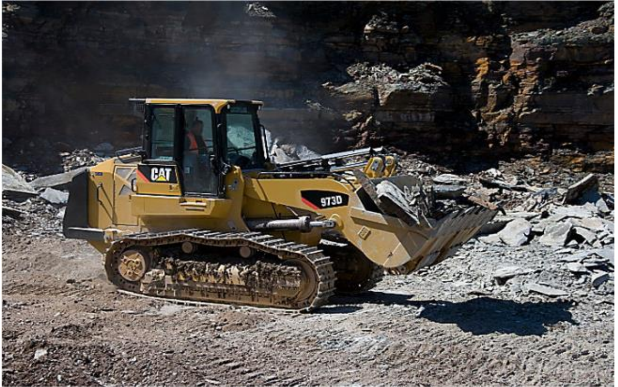
Figura 4 Carregadeira sobre esteira Caterpillar 973D
