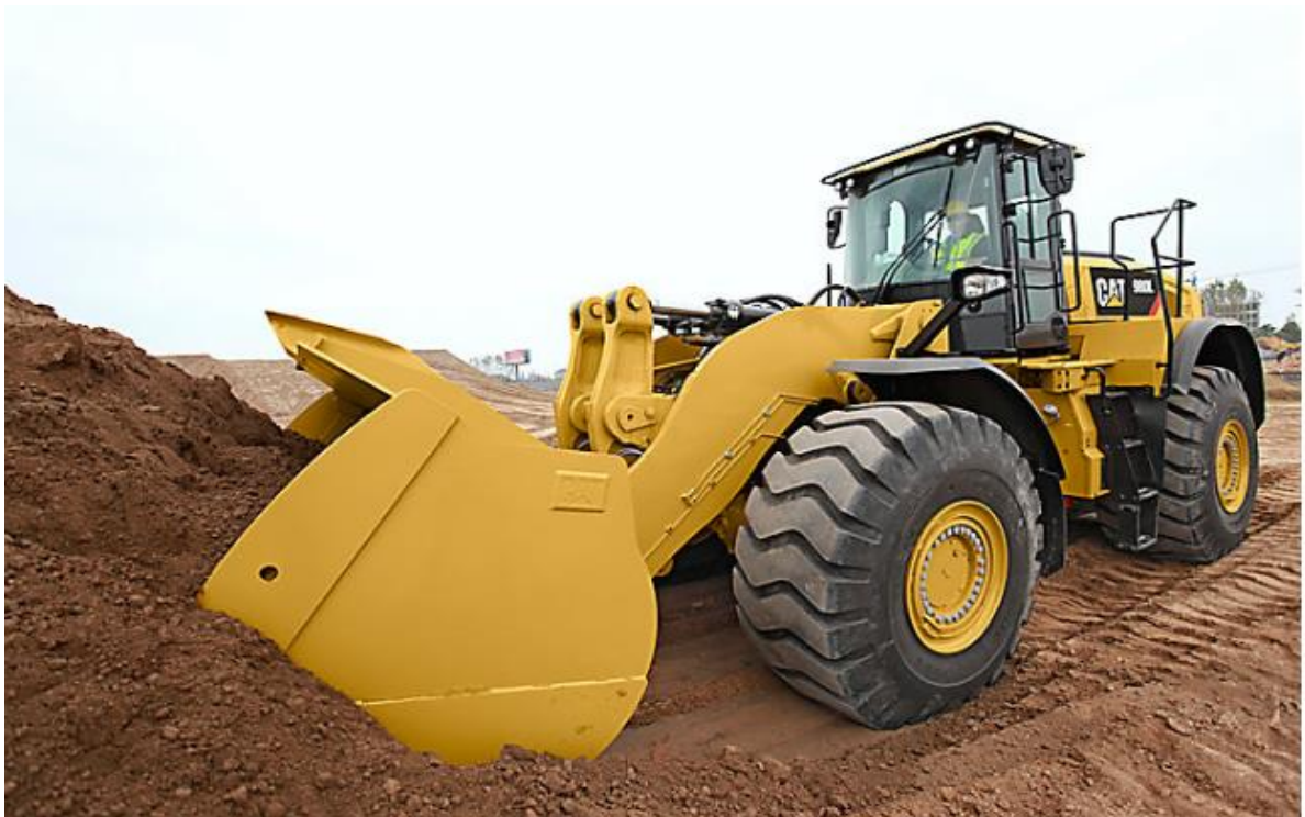
Figura 3 Carregadeira sobre pneus Caterpillar 980L
