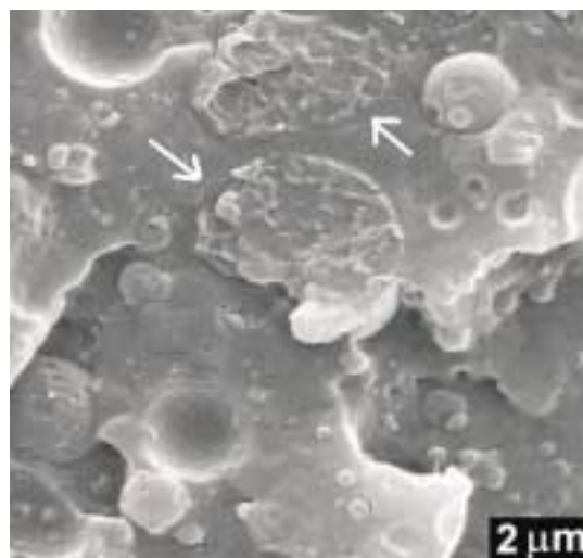
Figura 11. Detalhe da morfologia de uma blenda PP/HIPS (70:30) com 5% de SEBS. Aumento: 5000 X.
