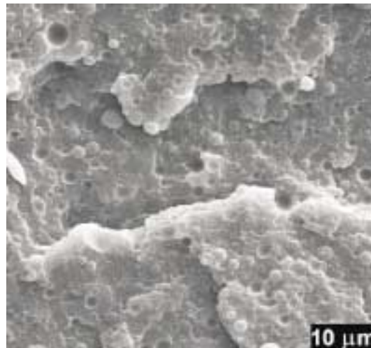
Figura 7. Morfologia de uma blenda PP/HIPS (70:30) com 2% de SEBS. Aumento: 1000 X.
