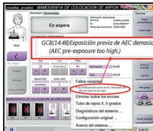
Fig. 2.3. Placa de plomo sobre el detector y compresor a una altura de 5,3 cm (izquierda); Ejemplo de mensaje de error que aparece en la consola del equipo (derecha).
