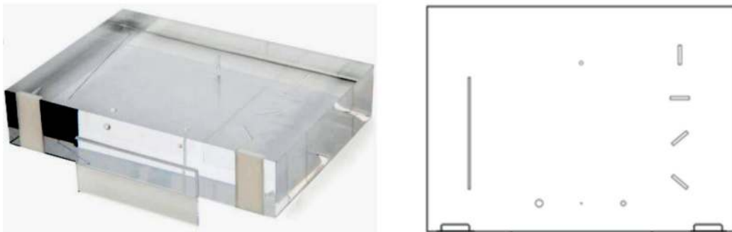
Fig. 3.6. (a) Maniquí Agatha formado por un bloque de PMMA de 4,5 cm de espesor en el que se han insertado los objetos de test mostrados en el esquema de la derecha. (Adaptado de https://www.leedstestobjects.com/ ).
