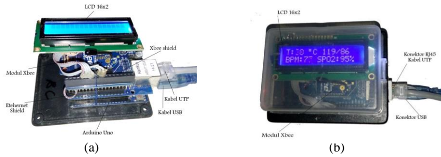
Gambar 4 Node sink (a) tampak luar, (b) tampak dalam
