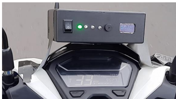
Gambar 8. Prototype Perangkat Memberikan Notifikasi Saat Melintasi Setpoint
