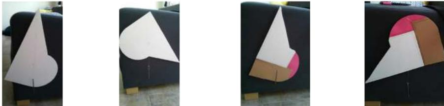
**Figura 3:** Pieza homogénea y heterogénea colgada de dos puntos diferentes y sus plomadas.
