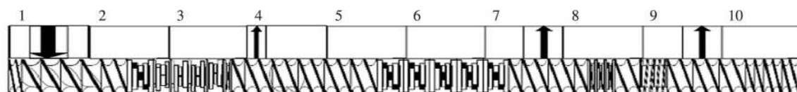
Figura 1. Perfil de rosca utilizado na extrusora dupla-rosca corrotacional.
