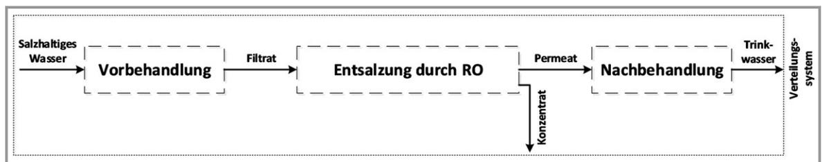
Abbildung 1. Typische Konfiguration einer RO-Anlage zur Trinkwasserproduktion aus Meerwasser.
